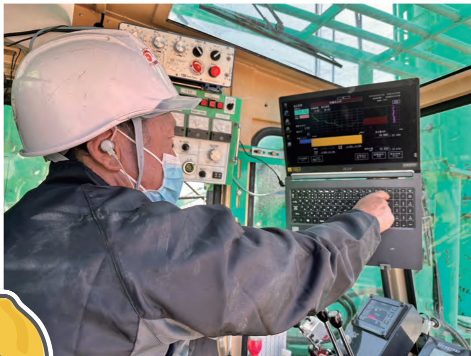
重機オペレーター室内の施工管理システム▲
